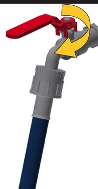
6. Chiudere il rubinetto dell'alimentazione idraulica
